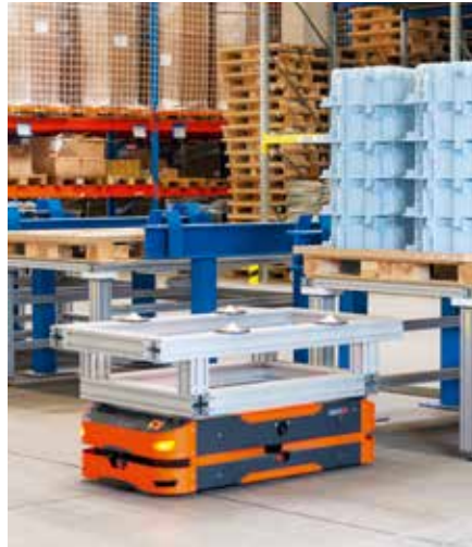
Zur Aufnahme der Paletten im Bahnhof hebt das fahrerlose Transportsystem seine Ladefläche um wenige Zentimeter an, zum Absetzen senkt es sie ab. Die Aufnahmevorrichtungen hat Wirthwein selbst gebaut.
