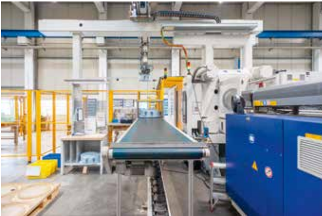
Die Spritzgießmaschinen geben die Produkte auf der Bedienseite aus – die Fertigteile zur Schließseite, die QS-Teile zur Einspritzseite. Die größeren Maschinen verfügen über eine Zuführung für die Einlegebuchsen (unter dem Förderband).
