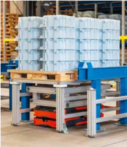
Zur Aufnahme der Paletten im Bahnhof hebt das fahrerlose Transportsystem seine Ladefläche um wenige Zentimeter an, zum Absetzen senkt es sie ab. Die Aufnahmevorrichtungen hat Wirthwein selbst gebaut.
