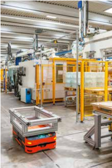
Die Fahrzeuge orientieren sich an festen, rechtwinklig platzierten Magnetstreifen auf dem Boden. Sie können sich auf der Stelle drehen. Zum Aufladen seiner Akkus hat jedes Fahrzeug eine eigene Parkposition.
