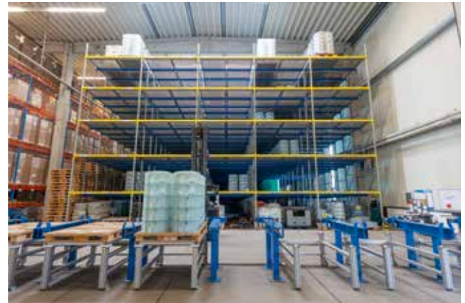
Am Bahnhof (im Vordergrund) vor dem Pufferlager setzt das fahrerlose Transportsystem befüllte Paletten ab und nimmt leere Paletten auf. Auf der Gegenseite übernimmt ein Stapler und hebt sie in das Pufferlager.
