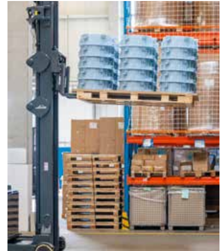
Um die 204 x 120 cm großen Sonderpaletten in das Pufferlager zu heben, wurden die Zinken der Stapler um 70 cm verlängert.
