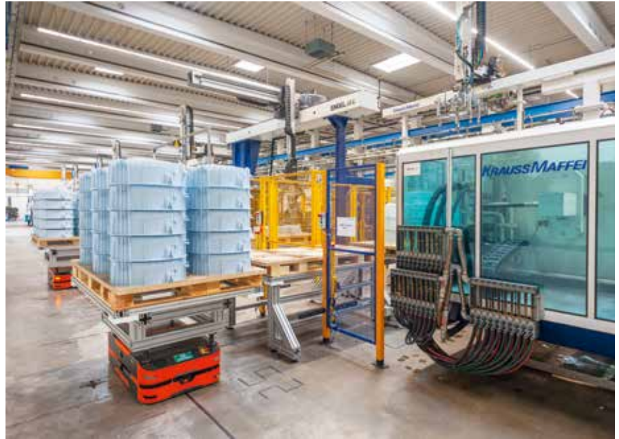
Die Stützen der Linearroboter an den verschiedenen Bestandsmaschinen erforderten mehrere Layouts, um die Palettenstellplätze an jeder Spritzgießmaschine optimal anzuordnen.
