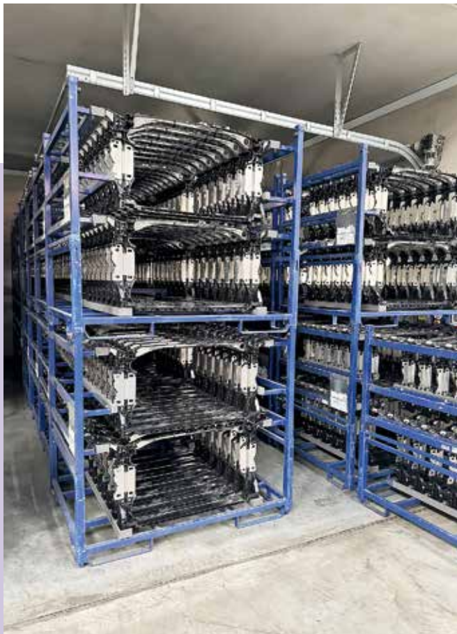
Dank speziell gestalteter Aufnahmen lassen sich die Kunststoff-Montageträger im Spezial-Ladungsträger transportieren.
