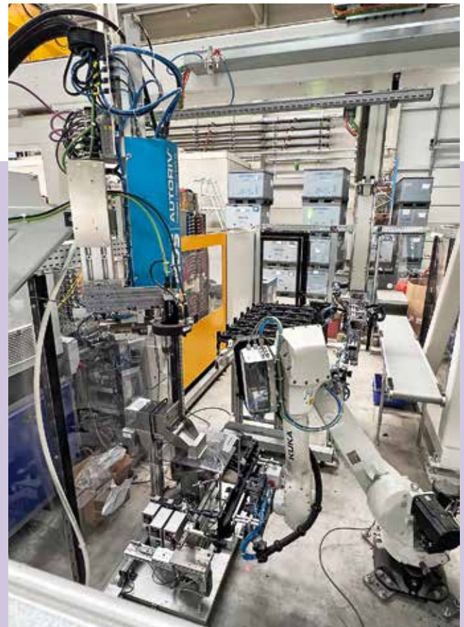
Auch das Spritzgießen der Kühllufteinlässe und die Montageumfänge in einer 8.000-kN-Spritzgießmaschine sind voll automatisiert.
